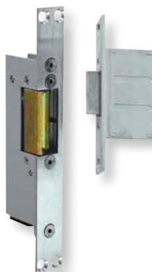
Les **verrous à mortaiser** D.A.S JPM sont des dispositifs électromécaniques destinés à renforcer la sécurité d'une issue de secours équipée d'un seul point de fermeture mécanique. Ils s'utilisent sur portes simple action avec le VE5000 ou double action en utilisant le VE6000.
